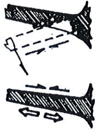
Przykłady zastosowania ściągacza linowego do obalania drzew.
