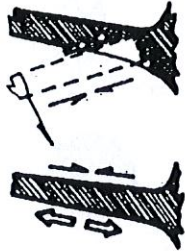
Przykłady zastosowania ściągacza linowego do obalania drzew.
