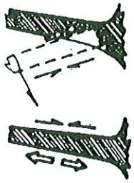
Przykłady zastosowania ściągacza linowego do obalenia drzew.
