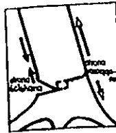
średnica pnia większa od użytecznej długości prowadnicy
